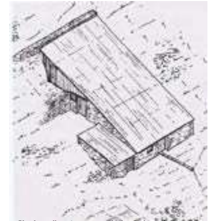
Chalet d'estive au col du Sabot à Vaujany : presque totalement enterré pour permettre aux avalanches de glisser dessus
